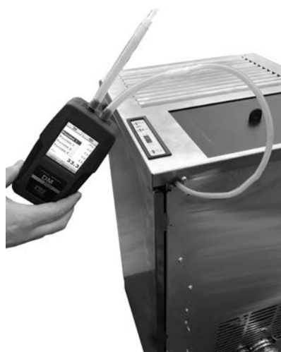
Fig. 27 - Ligação do pressóstato digital
